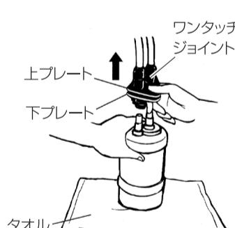
浄水カートリッジをキャビネット底板の上においたタオルの上で押えてください。
