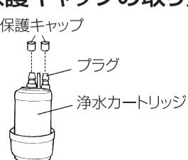
新しい浄水カートリッジの上端プラグに付いている保護キャップを取り外してください。(2ヶ)
