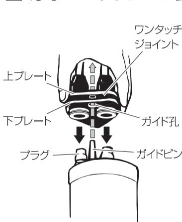
ワンタッチジョイントのプレートにあるガイド孔と浄水カートリッジのガイドピン及びプラグに合わせて垂直に「カチッ」と音がするまでしっかりと押し込んでください。
