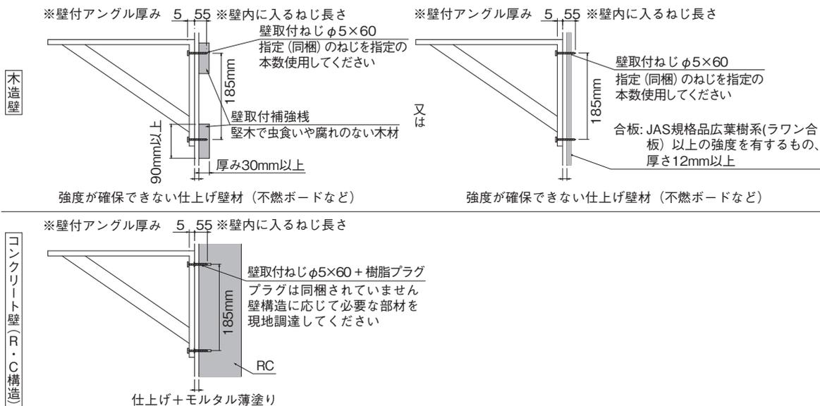
※壁取付ねじをねじ込み後、トルク管理を実施してください。(トルク数値: 3N・m)
