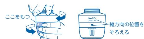
⑦ 浄水器本体の取扱説明書に記載の、「水栓金具への浄水器本体の取り付け方」にしたがい、浄水器本体を水栓に取り付ける。
