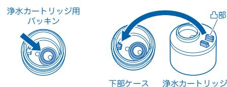
⑤ 浄水カートリッジ底面の凸部を下部ケース内部底面の凹部にあわせ、新しい浄水カートリッジを入れる。
