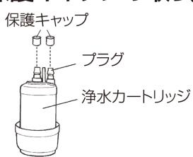
新しい浄水カートリッジの上端プラグに付いている保護キャップを取り外してください。(2ヶ)
