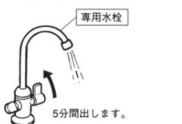
18 5分間放流したら、水栓のレバーを手前に倒して、浄水カートリッジの交換を終了します。
