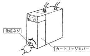
4 カートリッジカバーの両端を持ち、手前側に引き抜きます。
