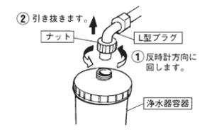
6 浄水器容器を反時計方向に回して取りはずします。
