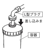
②オレンジ色のナットを手で時計方向に回して締めます。
