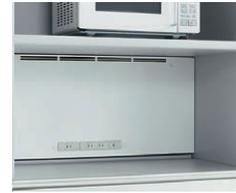
蒸気がこもらない電流感知式送風ファンを装備。炊飯器の作動(電流値2A以上)を検知し、蒸気がこもらないように自動的に送風開始します。
