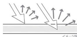
光が半透明素材の内部にまで入り込んで拡散反射し、全体が光って見える。
