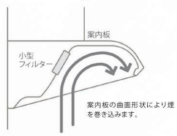
案内板の曲面形状によって、煙を「水平渦巻き状態」にキープしながら吸い込むことで、本体に入る手前でフィルターが油污れを吸着。これがトクラス独自の「フロントキャッチ方式」。
