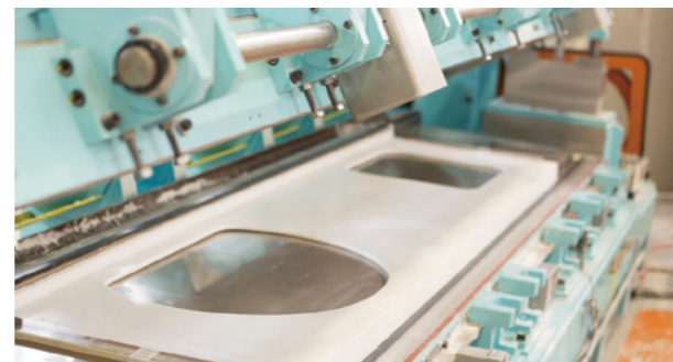
ダミーを用いた人造大理石の注型工程
